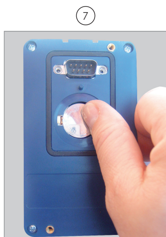
Presionar la batería para que encaje
