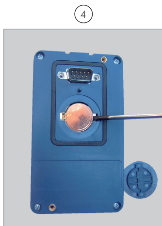
Remover la batería con el auxilio de un destornillador posicionado en el ángulo derecho
