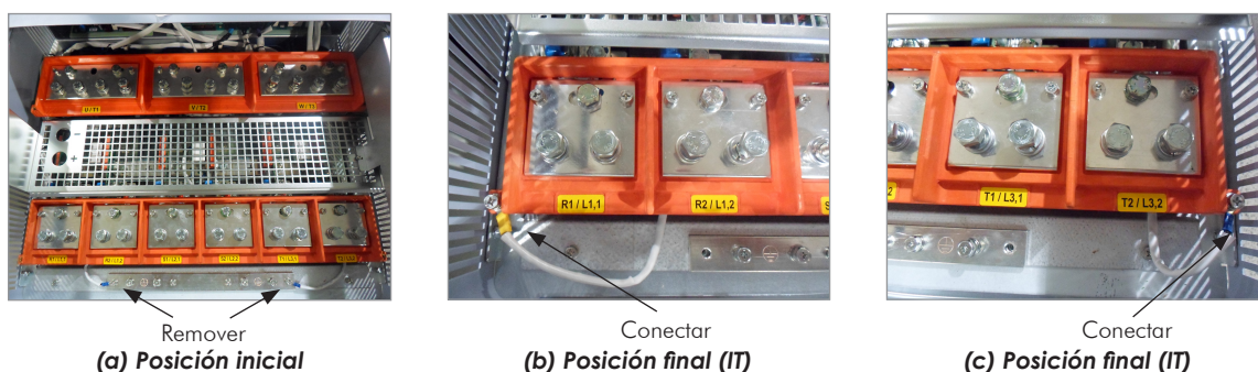
Figura 3.12 - (a) a (c) - Conexiones de puesta a tierra - localización y procedimiento para adaptación a redes IT o delta puestas a tierra - tamaño H
