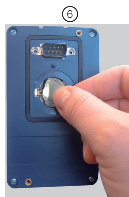
Colocar la nueva batería posicionándola primero en el ángulo izquierdo
