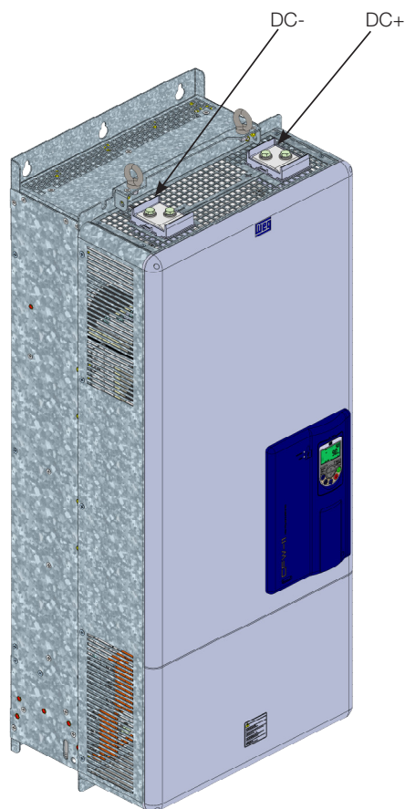
(b) Bornes para conexión del convertidor de salida
