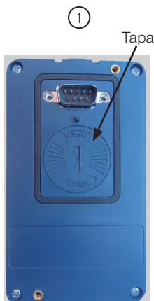
Localización de la tapa de acceso a la batería
