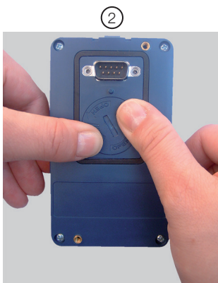
Presionar y girar la tapa en sentido antihorario
