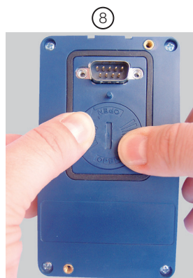
Colocar la tapa y girarla en sentido horario
