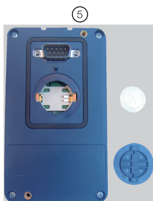
HMI sin la batería
